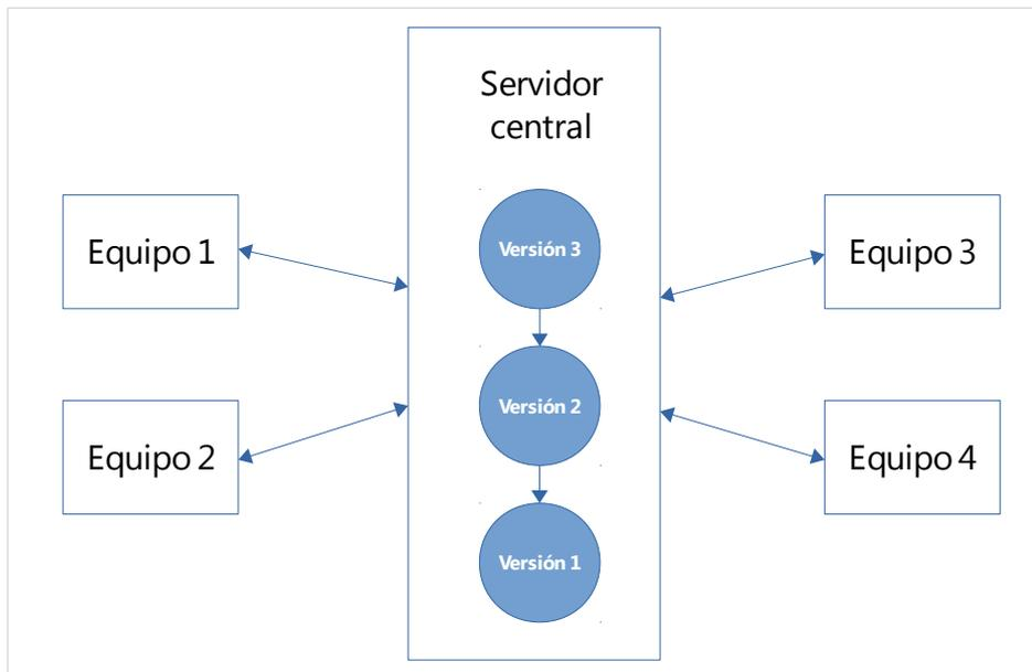
*Ilustración 2: Sistema de control de versiones centralizado.*
